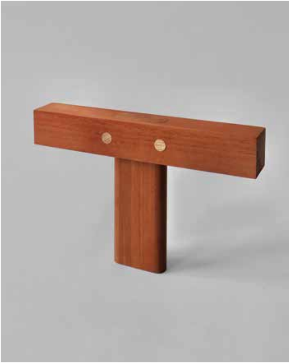
Primera maqueta realizada en eucalipto rojo en el taller de modelismo de Hildesheim, con la fresadora de precisión Shaper Origin. | Dibujos de Benjamin Seimer, que muestran el ensamble de madera como proyección e isometría de tres paneles.
