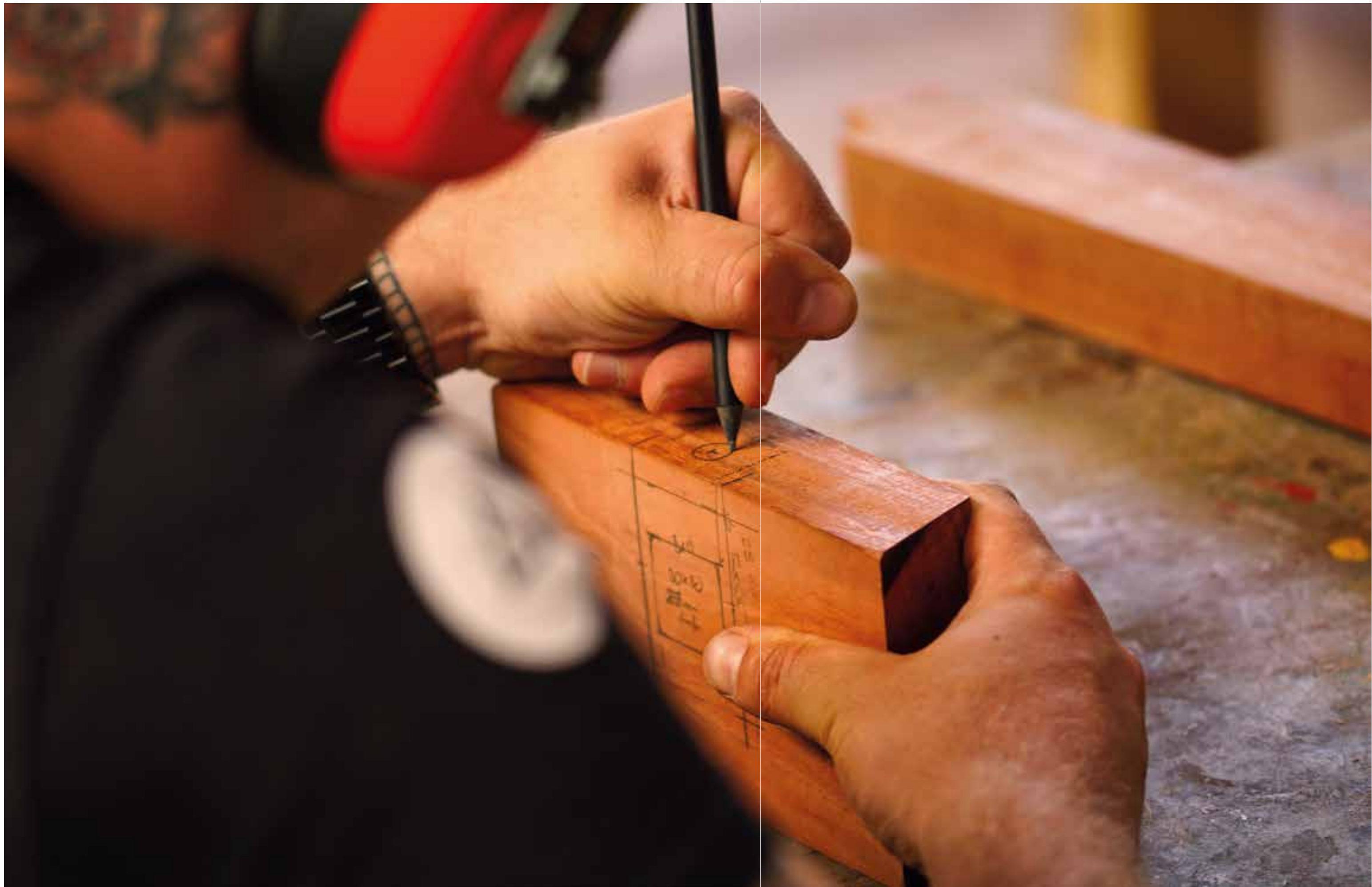
Las ranuras para la compleja conexión entre las patas y el anillo superior son marcadas directamente sobre la madera para verificar la posición y las distancias de los bordes. Diseño y ejecución se superponen aquí.
