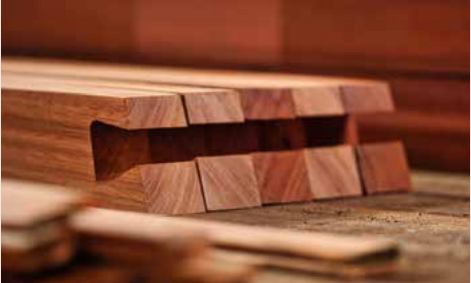
Los listones individuales como elementos de soporte se conectan por medio de oquedades fresadas en la parte delantera, cada una con una mariposa de forma especial. Esta producción pudo implementarse fácil y rápidamente con el Shaper Origin.
