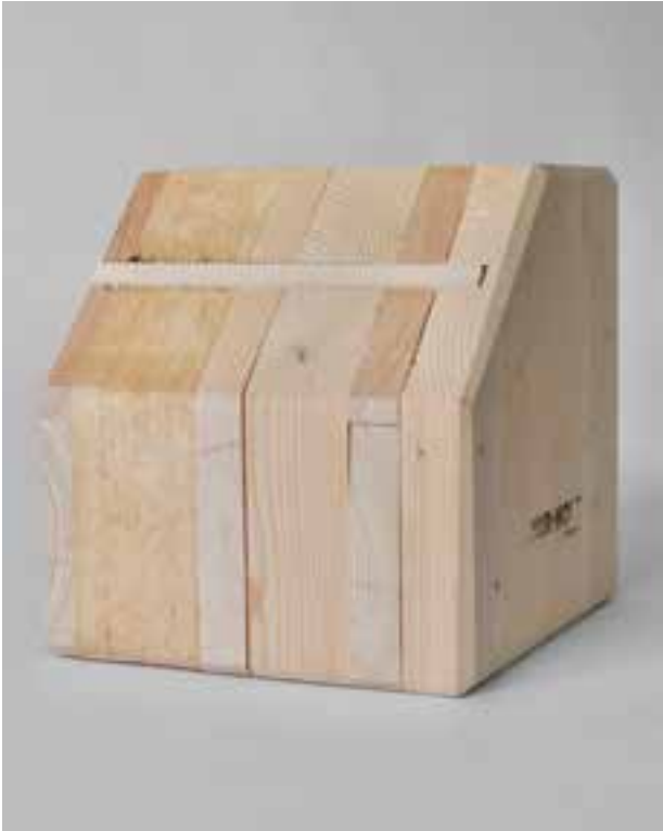
Tornillo de haya que fija las tablas de pino y el aislamiento de fibra de madera (Sistema ALL-WOOD). / Maqueta elaborada en el taller de Hildesheim, ensamble tipo mariposa para las patas de la pérgola (realizada con Shaper Origin).
