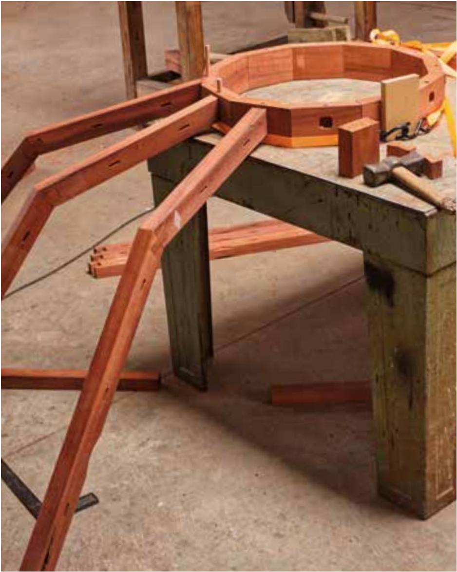
Las mariposas se ensamblan fácilmente con un golpe seco. | En el primer test, los listones superiores de los elementos de soporte se fijan al anillo de presión con tacos de madera.
