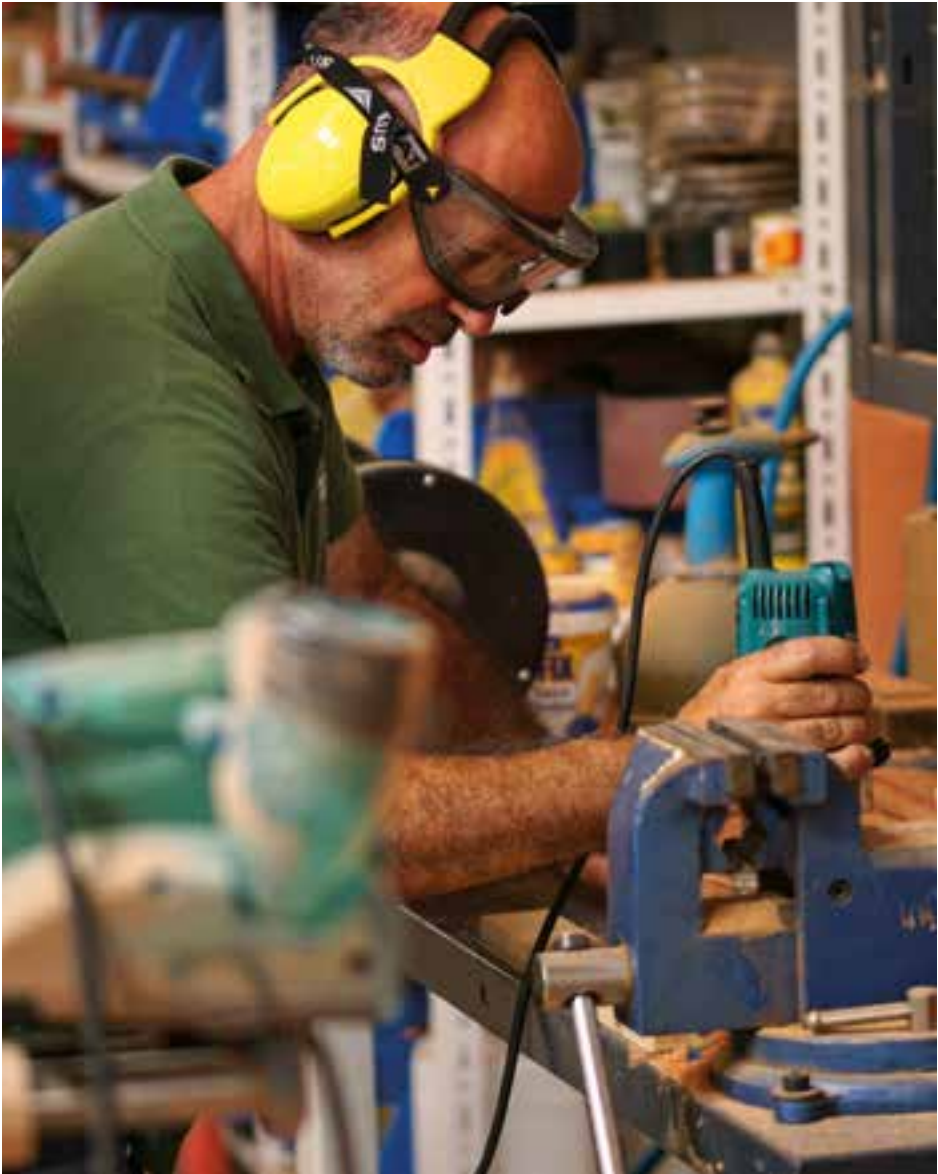
Las delgadas tiras de madera se almacenan y esperan a su posterior procesamiento para su uso como riostras para reverdecer la pérgola. | Los bordes de las tiras se redondean con la fresadora.
