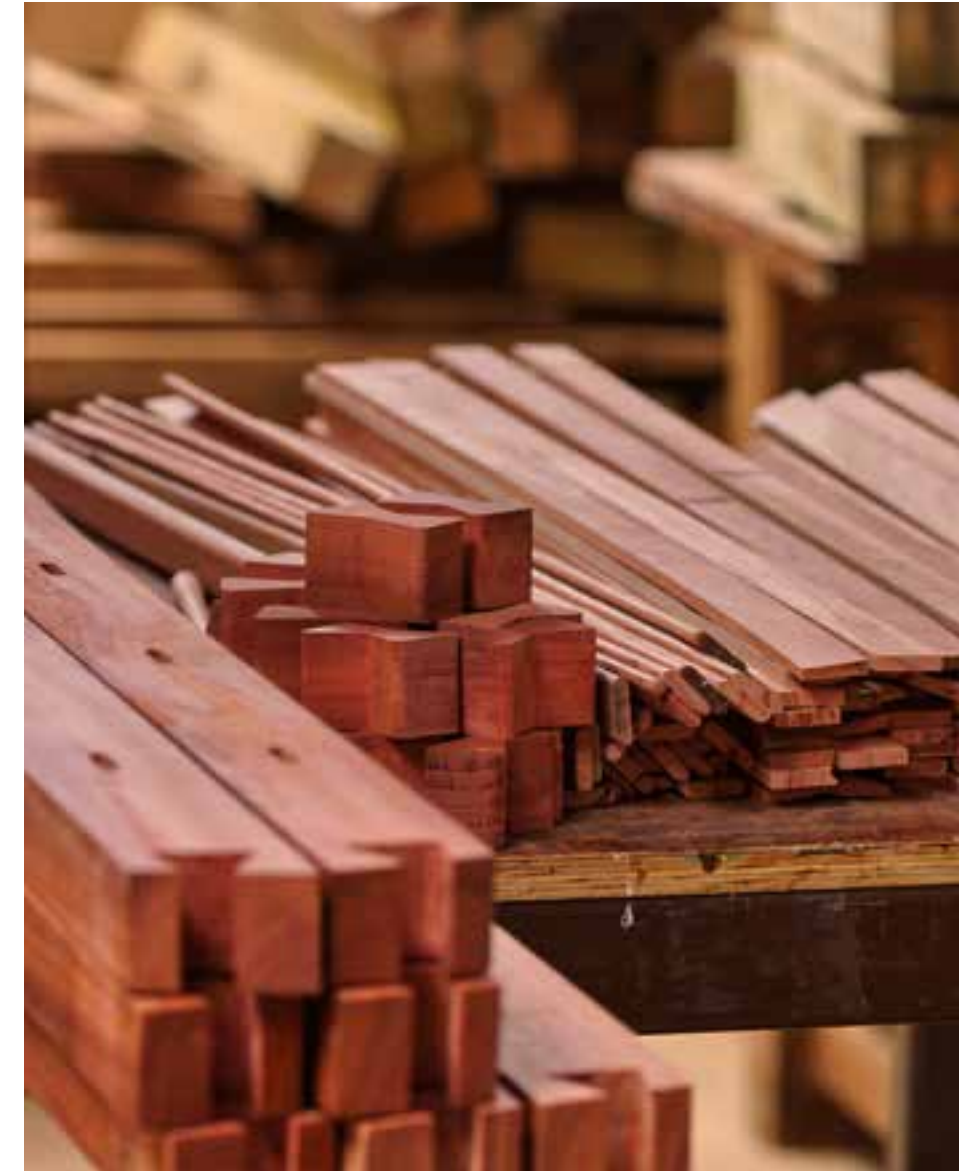
Piezas prefabricadas de madera a la espera de un ciclo de lijado fino que mate los cantos, para el posterior montaje final.
