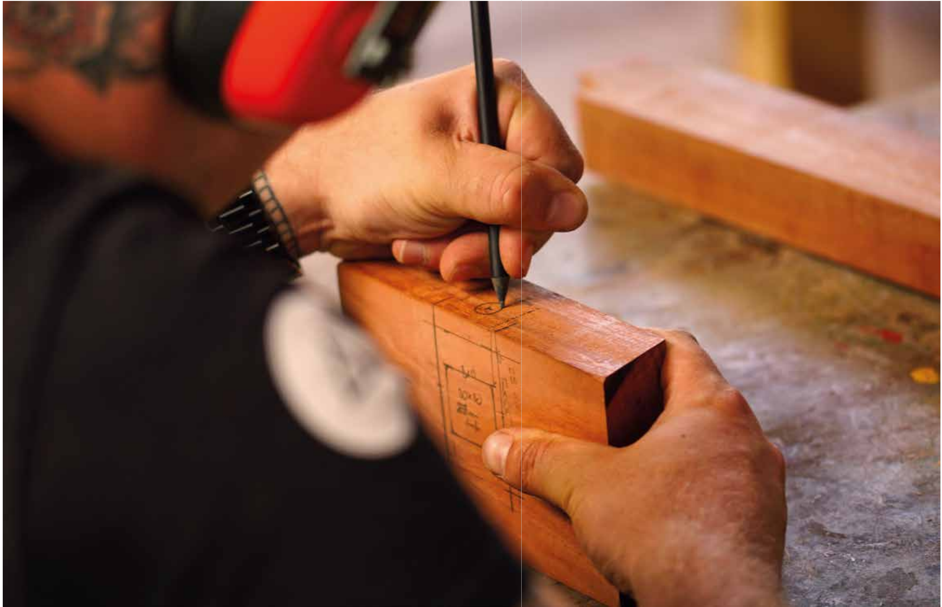
Aussparungen für die komplexe Verbindung von Stütze und Ring werden auf dem Holz für das Druckringsegment direkt angerissen, um Lage und Randabstände zu prüfen. Entwurf und Ausführung überlagert sich hier.
