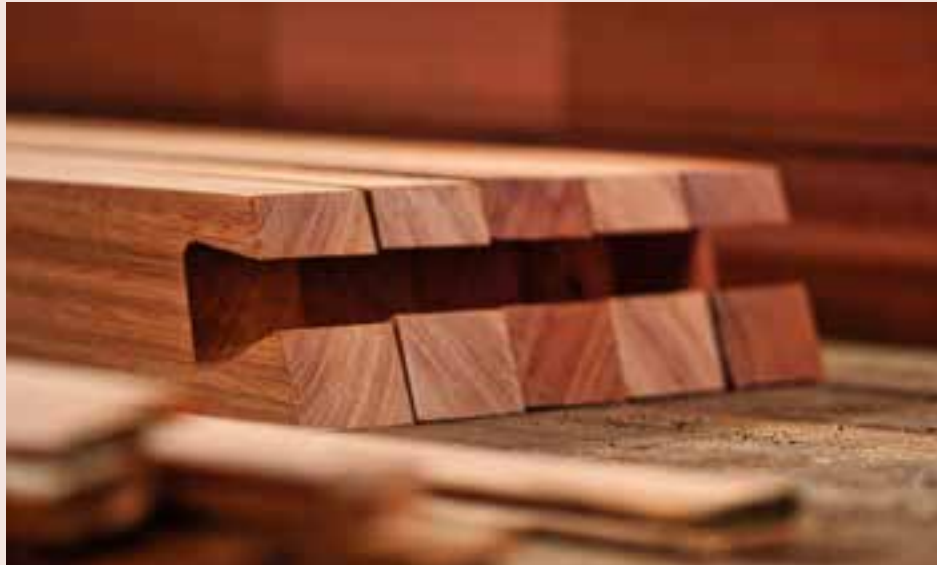
Die einzelnen Kanthölzer für die Stützelemente werden in stirnseitigen ausgefrästen Taschen mit jeweils einem speziell geformten Butterfly kraftschlüssig verbunden. Diese Fertigung ließ sich einfach und schnell mit der Shaper Origin umsetzen.
