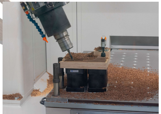
Bild links: Fräspfade in ALPHACAM (Fuß) Bild oben: Live-Bild der Fräsung eines Fußes
