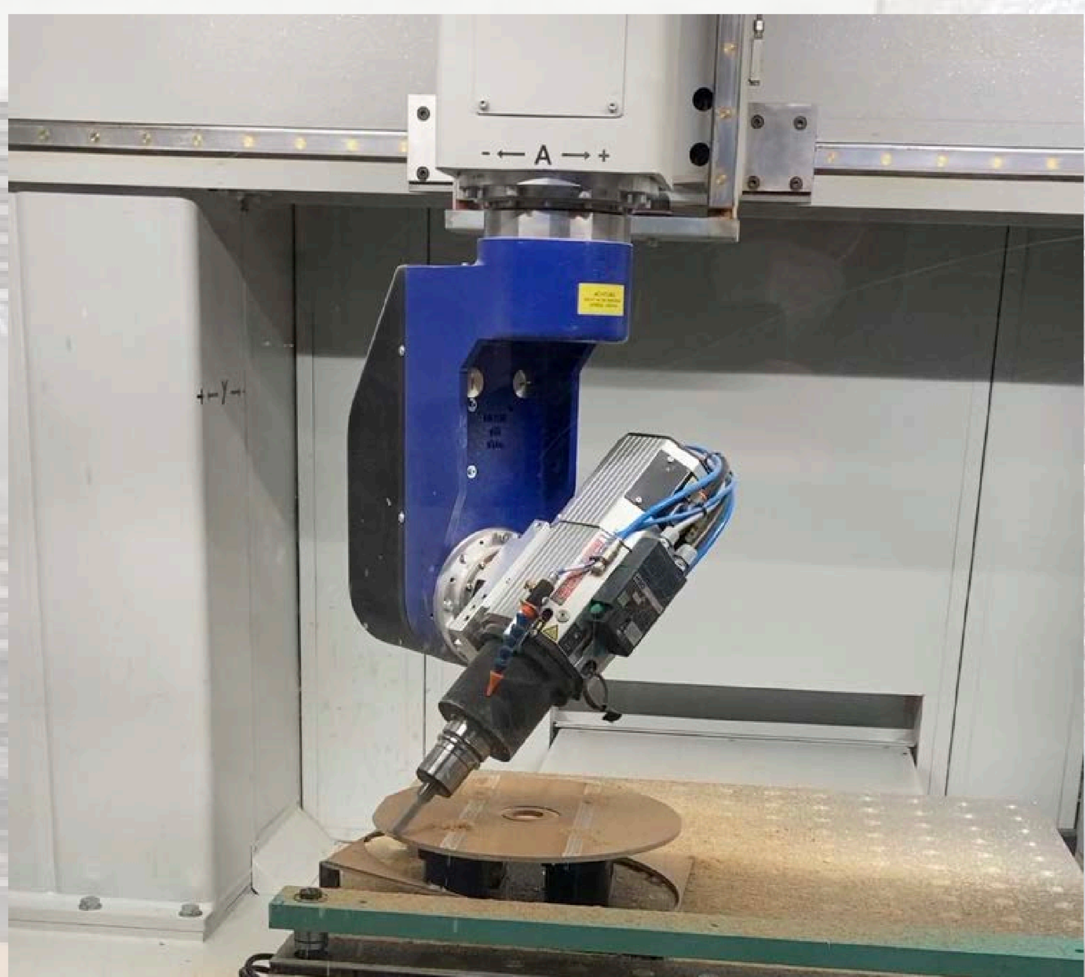
Bild links: 5-achssimultan Formatierung des oberen Konstruktionsbodens Bild rechts: fertige Deckenlampe
