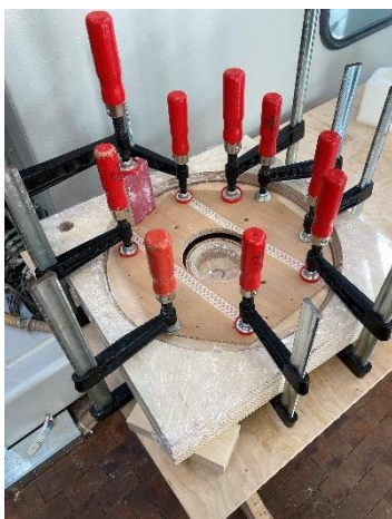
Abb. 49: Verleimung Boden/Schirm (eigene Darstellung)
