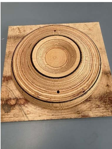
Abb. 35: Formatierschablone Schirm unten (eigene Darstellung)
