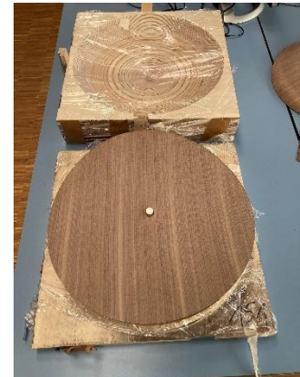
Abb. 27: Furnierblatt aufgefädelt (eigene Darstellung)
