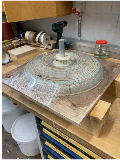
Abb. 30: Pressform mit Führung (eigene Darstellung)
