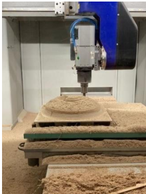
Abb. 20: Fräsvorgang Schirm unten (eigene Darstellung)
