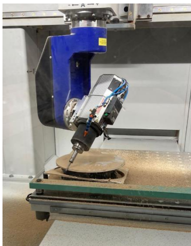
Abb. 38: Fräsvorgang Konstruktionsboden (eigene Darstellung)
