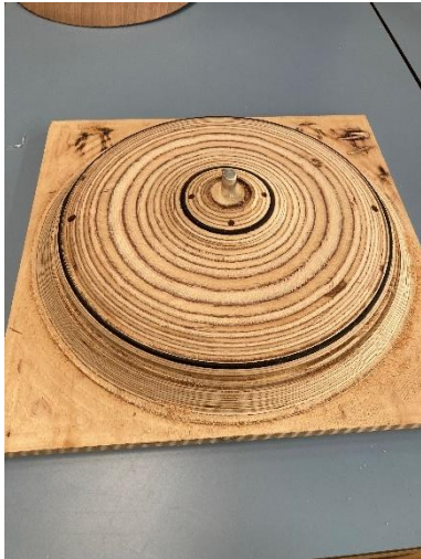
Abb. 33: Formatierschablone Schirm oben (eigene Darstellung)
