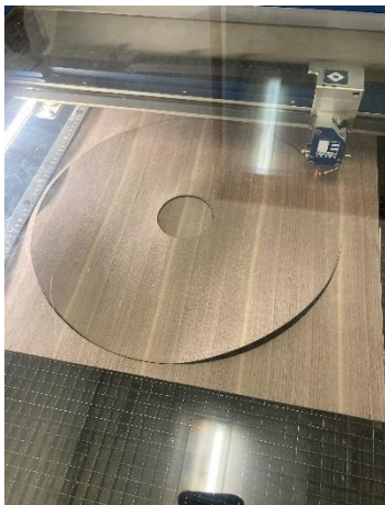
Abb. 23: Lasern der Furniere (eigene Darstellung)
