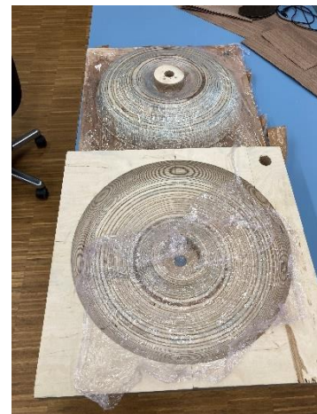
Abb. 22: Pressform Schirm unten (eigene Darstellung)
