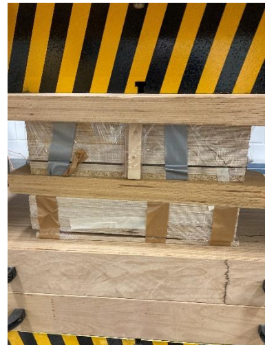
Abb. 31: Pressvorgang Schirm oben/unten (eigene Darstellung)
