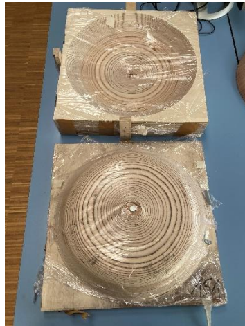
Abb. 21: Pressform Schirm oben (eigene Darstellung)
