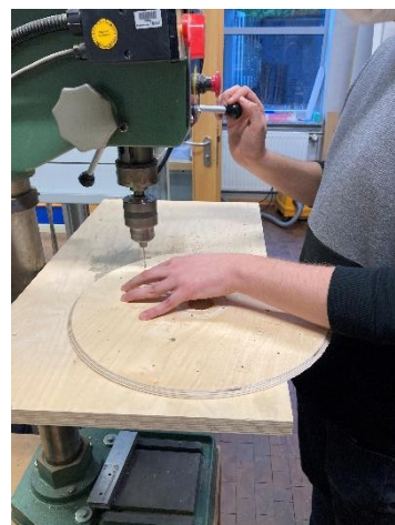
Abb. 39: Nachbearbeitungen an der Ständerbohrmaschine (eigene Darstellung)
