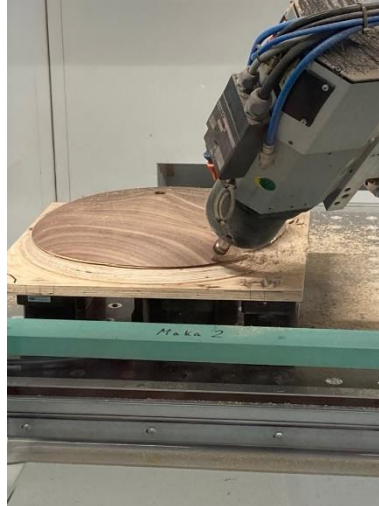
Abb. 34: Formatiervorgang Schirm oben (eigene Darstellung)
