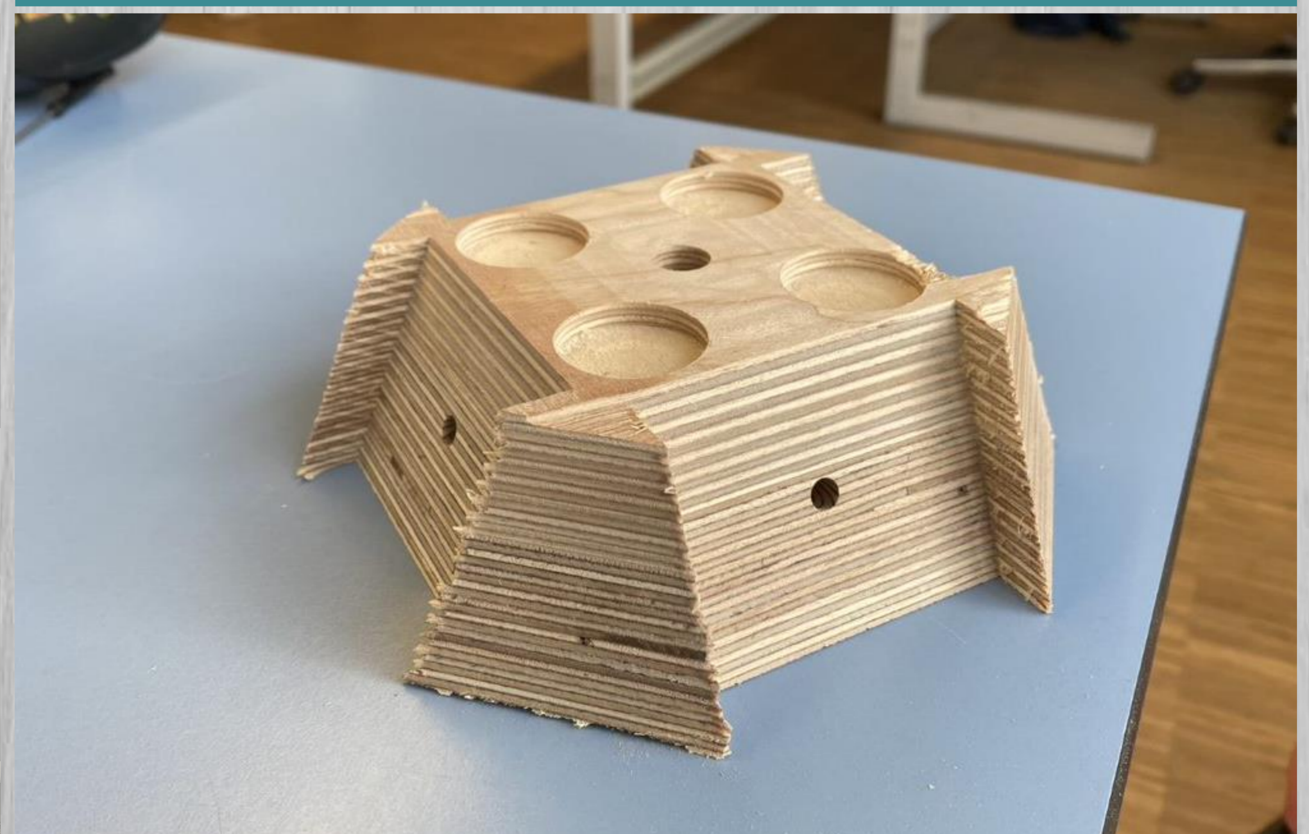
Bild links oben: 5-Achs Fräsen der unteren Pressform Bild links unten: Formatierung einer Korpushälfte Bild rechts: Ergebnis des 5-Achs Fräsens des Verbindungsklotzes
