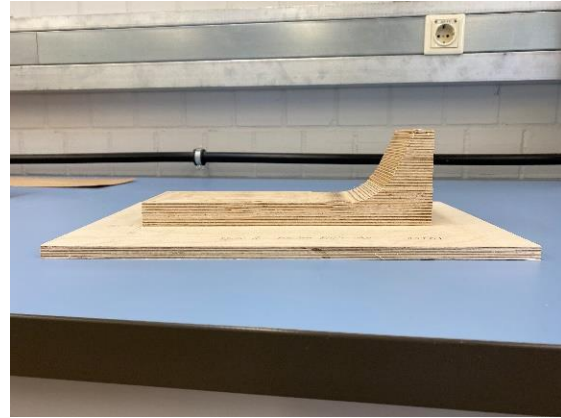
Abb. 27: Untere Pressform Füße (Eigene Darstellung, 757492)
