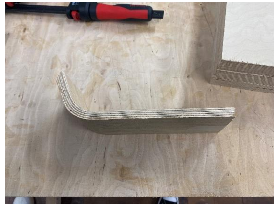
Abb. 31: Fertig gepresster Fuß (Eigene Darstellung, 757492)
