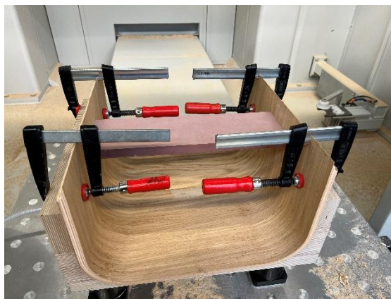
Abb. 14: Formatierung der vorderen Bearbeitung mit Lehre (Eigene Darstellung, 757735)
