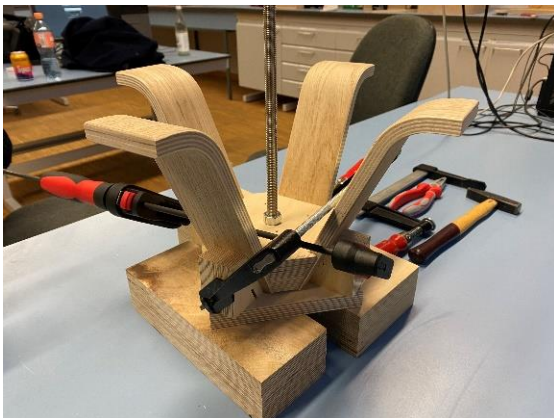
Abb. 51: Verleimen der Füße mit dem Klotz (Eigene Darstellung, 757492)
