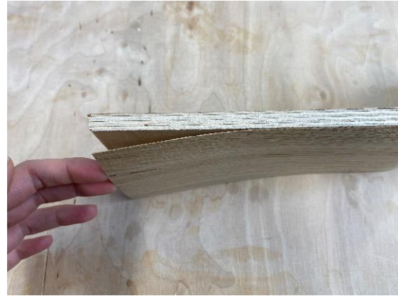
Abb. 29: Ablösen des Furniers (Eigene Darstellung, 757492)
