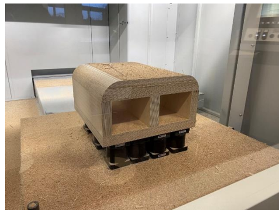
Abb. 4: gerästes Fertigteil der unteren Pressform (Eigene Darstellung, 757735)
