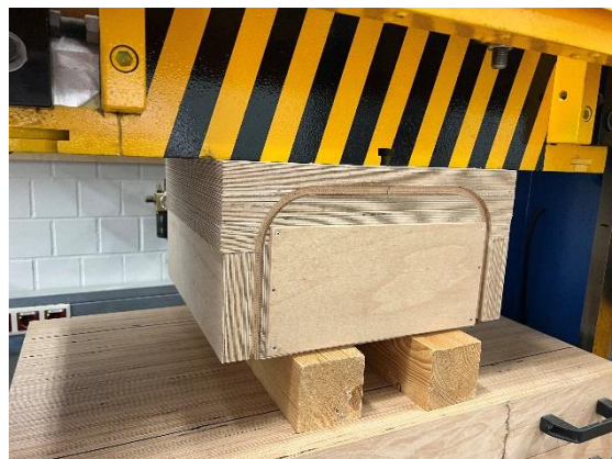
Abb. 10: Korpshälfte in der Presse mit Gegenform (Eigene Darstellung, 757735)
