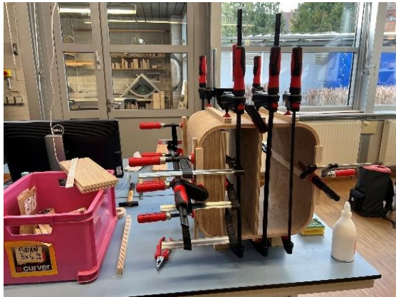
Abb. 47: Verleimprozess der Korpushälften (Eigene Darstellung, 757492)
