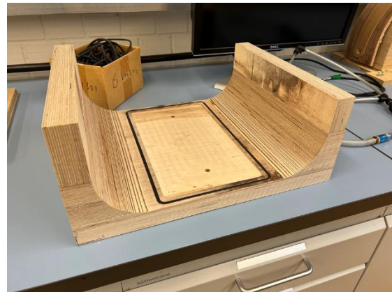
Abb. 7: Fertige Formatierungsform mit Seiten und Vakuumentasche (Eigene Darstellung, 757735)
