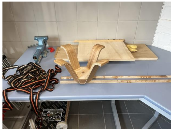
Abb. 56: Ölen des Gestells (Eigene Darstellung, 757735)
