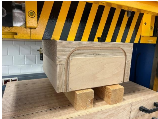
Abb. 15: Korpushälfte in der Presse mit Gegenform (Eigene Darstellung, 757735)
