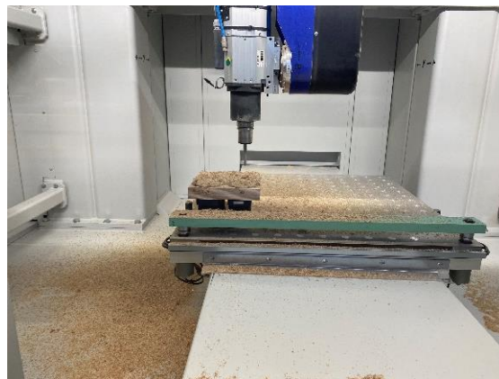
Abb. 43: Fräsen der Klötze (Eigene Darstellung, 757492)
