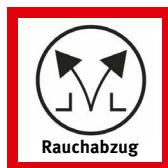
Rauch- und Wärmeabzugsanlagen (RWA) sind dafür da, Fluchtwägen (z. B. Treppenräume, Flure, Eingangshallen) im Brandfall zu entlüften, damit giftige Rauchgase abziehen können. So können Fluchtwägen länger zur sicheren Räumung genutzt werden. Wenn der Fluchtweg verraucht und eine RWA vorhanden ist, lösen Sie den Rauchabzug per Knopfdruck aus. Die Kästen der Auslöseknöpfe sollen orange sein, können jedoch unterschiedliche Farben haben und sind immer mit „Rauchabzug“ beschriftet.
