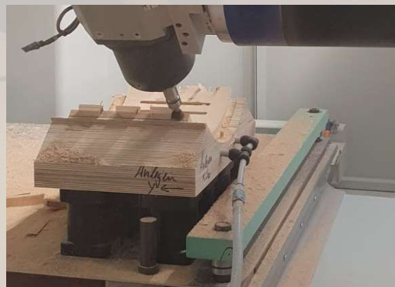
Bild links: Formatierung Bild rechts: Fräsen der Schwalbenschwänze im Schirm
