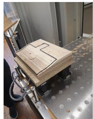
Abb. 17 - neue Spannvorrichtung
