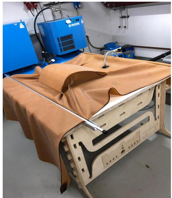
Abb. 28 - Biegung der Rückwand im Vakuumsack
