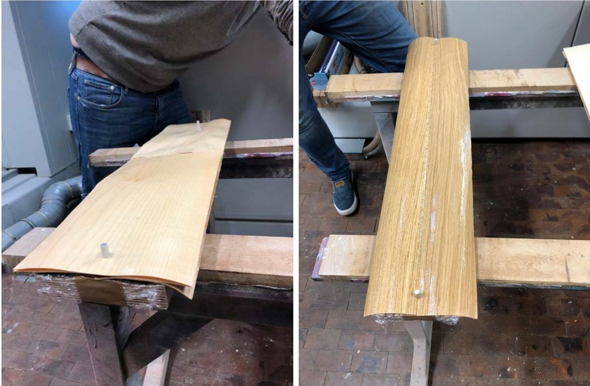
*Abb. 34 - Positionierung und Pressung der Rahmenteile*
