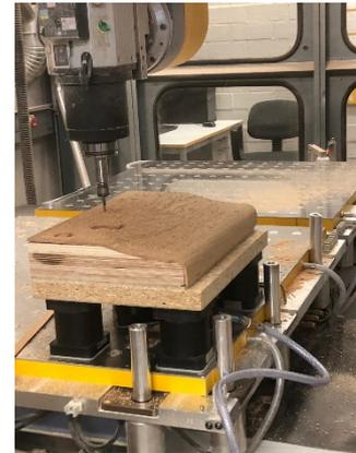
Abb. 18 - Fräsen mit neuer Vorrichtung
