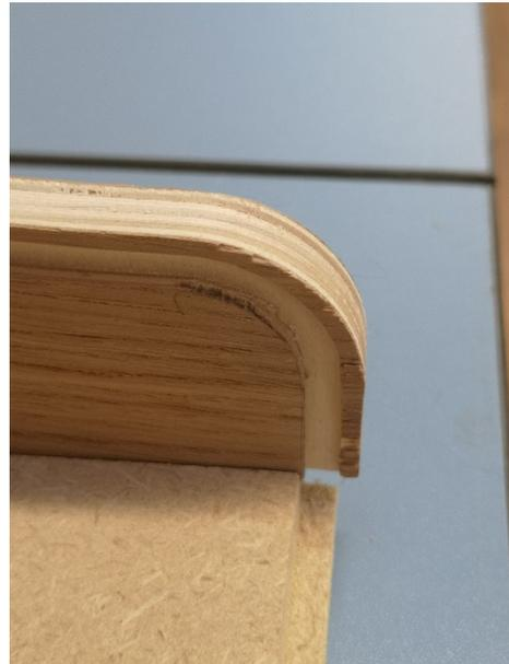
Abb. 32 - Fehlerstellen, Seitenteil
