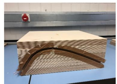
Abb. 22 - Rückwand in Pressform
