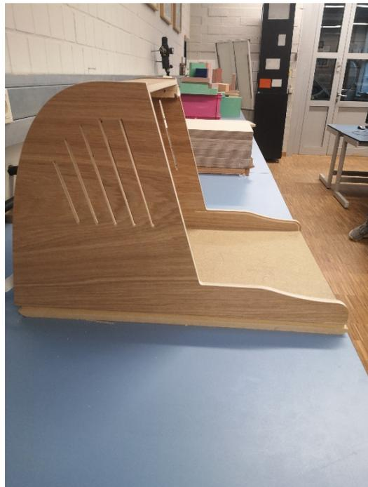
Da die Teile gut passten, begann man nach dem Schleifen aller Teile nun mit dem Verleimen des Korpus.
