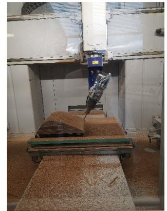
Abb. 20 - Fräsung der Rückwand-Pressform
