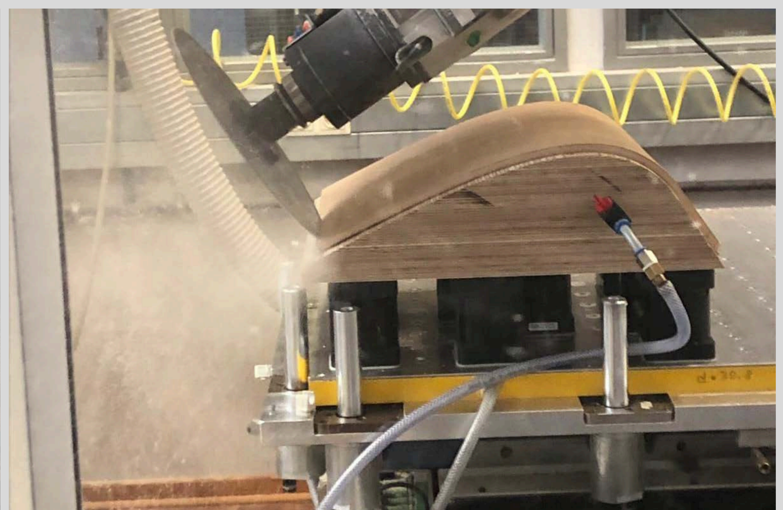
Bild links : Fräsen der unteren Pressform für das Rückenteil Bild rechts: Formatierung des Rückenteils
