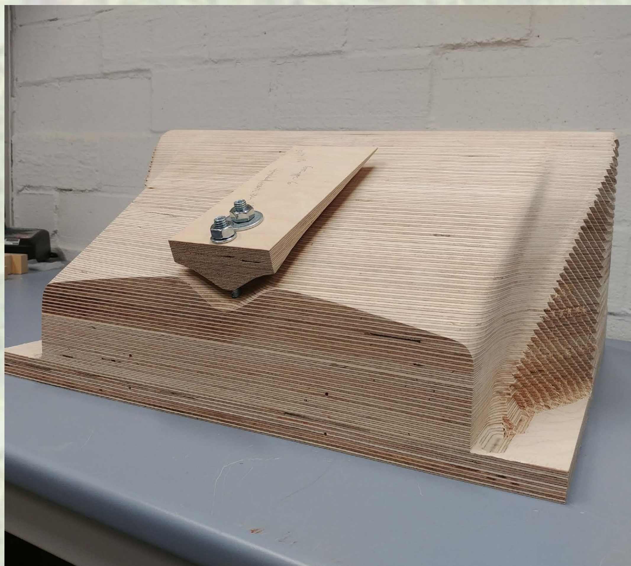
Bild links : Vakuumpressform mit Gegenstück für die Sitzschale Bild Mitte: 5-Achs-Simultanbearbeitung der Holme Bild rechts: Schichtvorgang an der Holmpressform
