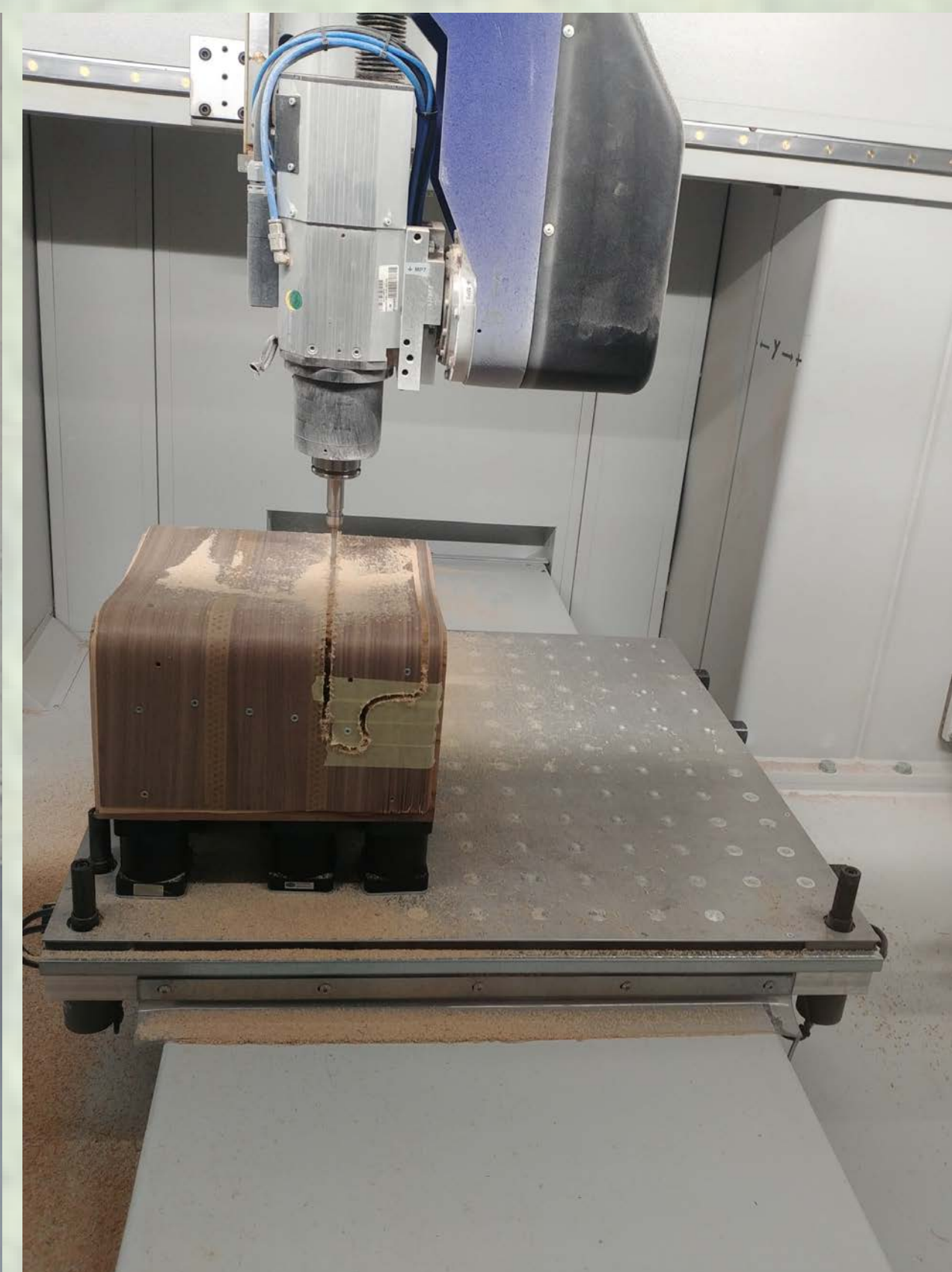
Bild links : Vakuumpressform mit Gegenstück für die Sitzschale Bild Mitte: 5-Achs-Simultanbearbeitung der Holme Bild rechts: Schichtvorgang an der Holmpressform
