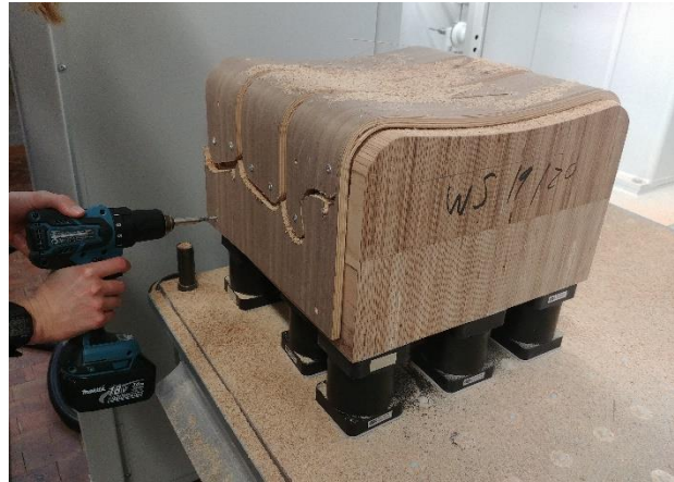
Abbildung 19 - Fixierung des Rohlings an der Pressform
