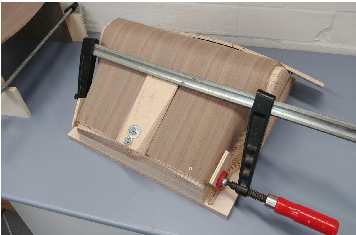
Abbildung 13 - Herstellung der Sitzschale / Konditionierung
