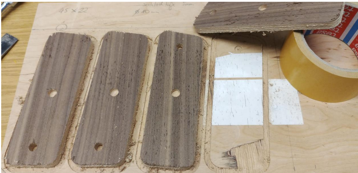
Abbildung 22 - Fixierung der Einzelteile mit doppelseitigem Klebeband
