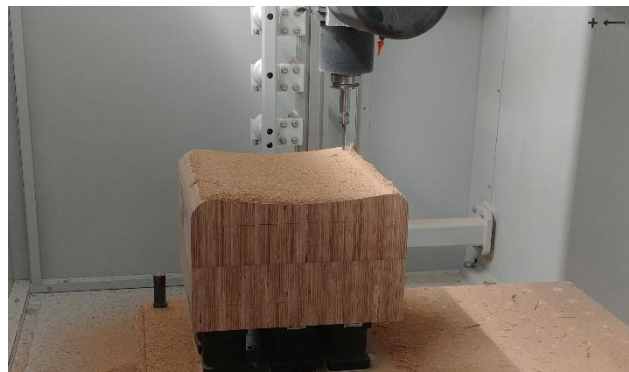
Abbildung 15 - Herstellung der Holm-Pressform
