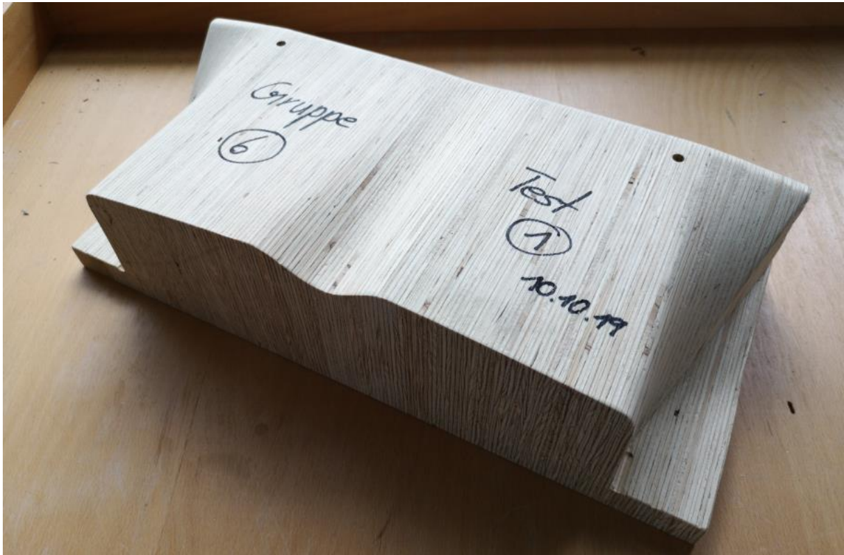
Abbildung 6 - Sitzschale Pressform Versuch 1
