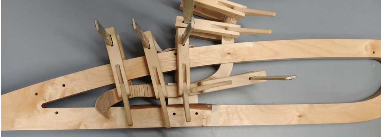
Abbildung 26 - Verleimung der Bremskomponenten
