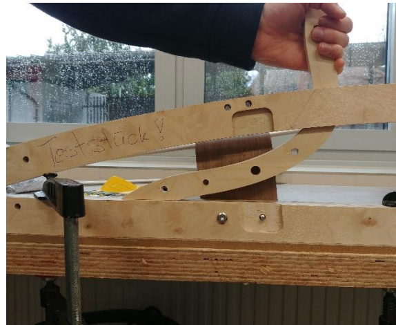
Abbildung 24 - Einbau der Bremsbasis
