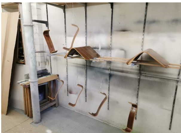
Abbildung 20 - Holme und Sitzschalen bei der Trocknung
