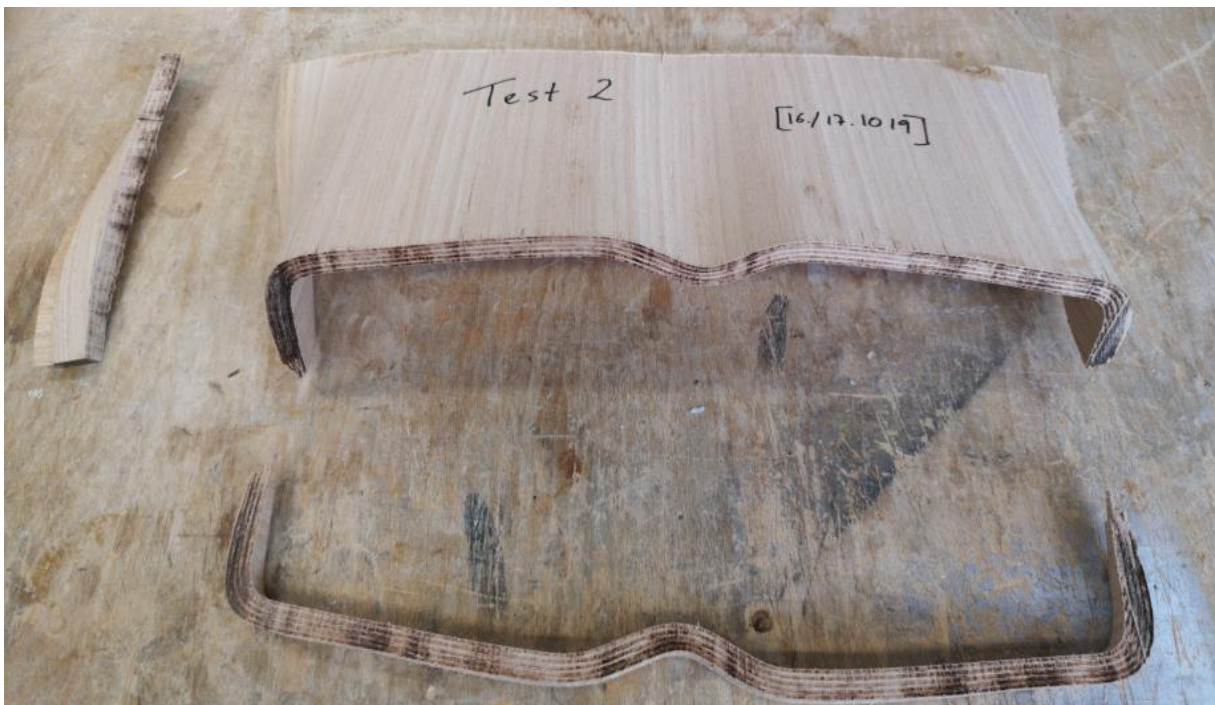
Abbildung 9 - Versuch 2 mit zufriedenstellender mittlerer Verformung
