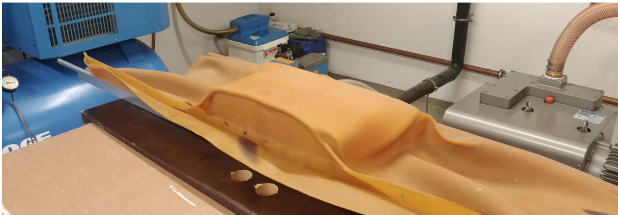
Abbildung 7 - Sitzschale Versuch 1 in der Vakuumpresse
