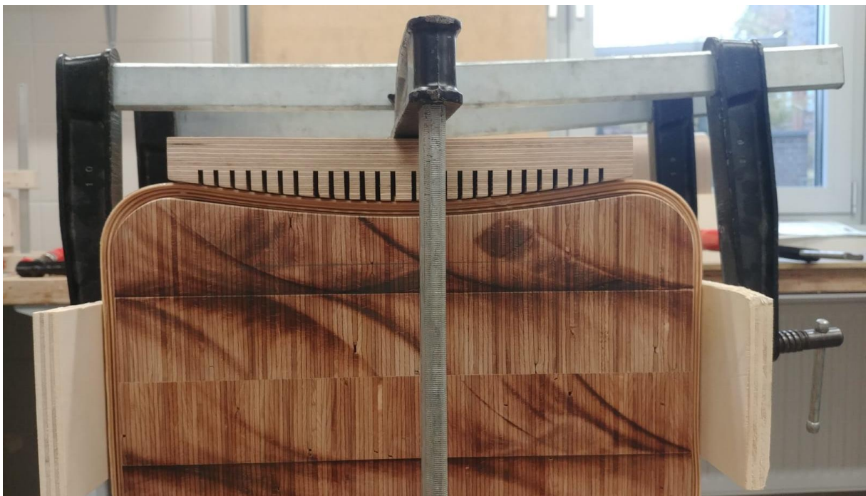
Abbildung 17 - Konditionierung des Holmrohling
