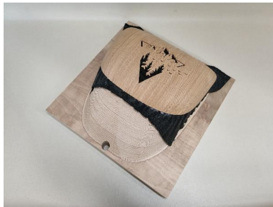
Abbildung 12 - Stoffverklebung mittels Pressform
