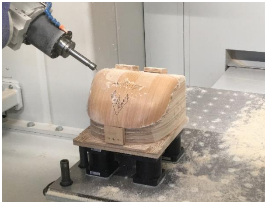
Abbildung 8 - Fräsung mit Klemmhilfen
