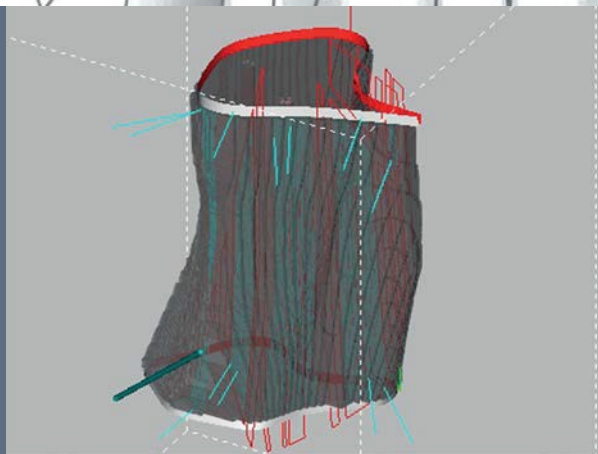
Bild links: Programmierung der NC-Bahnen Bild rechts: Simulation der 5-Achs-Bearbeitung
