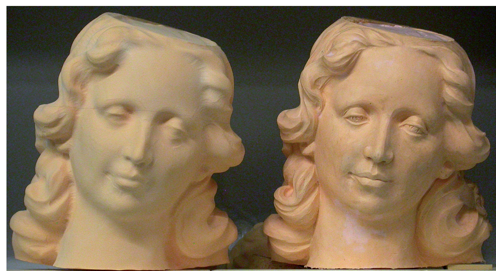
PUR-Modell vor der Nachbearbeitung (links), modellierter Kopf (rechts)
